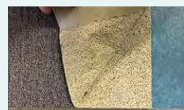
ルーフィングをレイヤコートC塗膜材から剥がすと塗膜材ごと剥がれ、完全に塗膜材と接着していることがわかります。
