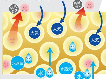
時間が経つことに気泡内のガスが抜け、ガスより断熱性の低い大気に入れ替わります。断熱材が吸湿吸水した場合も断熱性が低下します。
