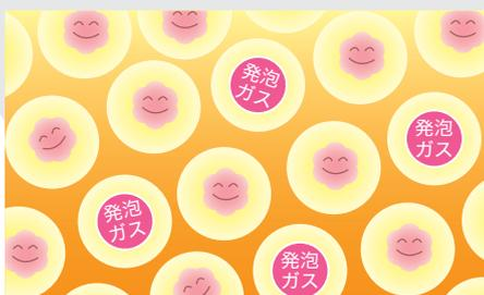
新しい断熱材は、内部の気泡の中に、断熱性能の高い発泡ガスが閉じ込められています。
