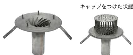
改修用排水量改善たて型二重ドレン。排水口の羽根形状で排水量を増加する画期的な構造。新築時の直径100mm縦引きドレンと同等の排水力。
