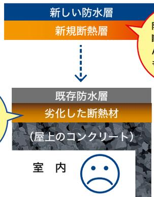
防水改修時に断熱材を組み込んで、断熱性能も回復!
