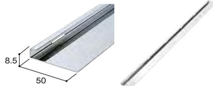
ステップスクエア500H、ガムロンタイルの端部保護を兼ねた、ステンレス製見切り材。VTテープ50を用いて固定する。側面に水抜用の穴(6カ所)あり。
