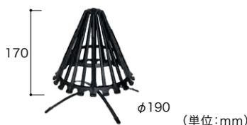
アルミダイキャスト製縦引き用ドレンキャップ。ステンレス製板バネ(樹脂製滑り止め付)をドレン内部に差し込んで設置。
