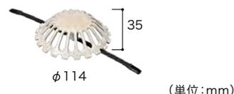
アルミダイキャスト製縦引き用ドレンキャップ。ステンレス製板バネ(樹脂製滑り止め付)をドレン内部に差し込んで設置。
