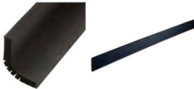
立上り防水層を、保護コンクリートの挙動から保護する発泡ポリエチレン製緩衝材。裏が粘着面で、立上り際の下地になじむよう切込み入り。
