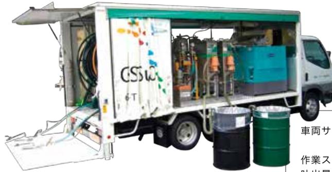
車両サイズ(2t) 全長:6.21m/幅:2.2m/
